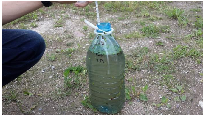
2.3 pav. Vandens mėginio temperatūros matavimas ėmimo vietoje
