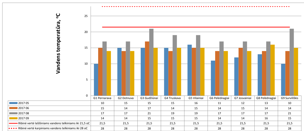
2.14 pav. Paviršinio vandens telkinio temperatūra (ribinė vertė lašišiniams vandens telkiniams iki 21,5 °C, ribinė vertė karpiniams vandens telkiniams iki 28 °C)
